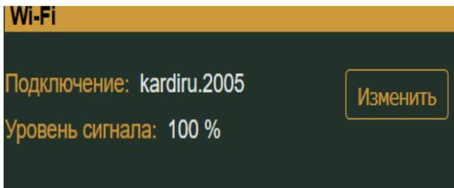
В настройках задать действующую сеть Wi-Fi и прописать пароль для подключения к этой сети. После подтверждения настроек устройство перезагрузится и попытается подключиться к настроенной сети Wi-Fi.
